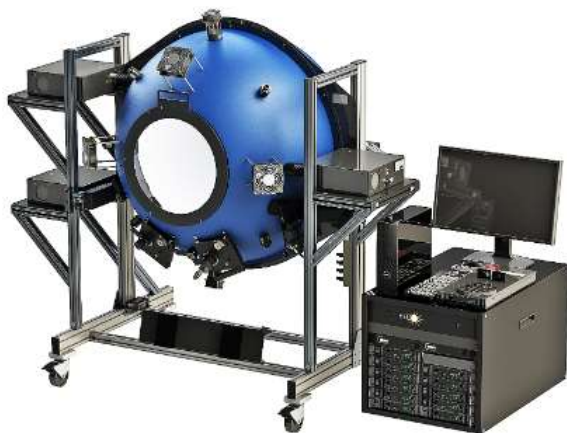
冷却付きハイパースペクトルカメラ校正用均一光源
