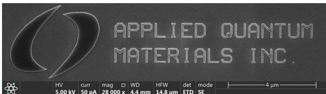
Figure1. 400uC/cm 2 (RAITH150 Two 30kV)で露光し、90 秒間 MF-319 の中で現像され、それから 60 秒間、脱イオン水でリンスされた AQM 社ロゴの SEM 画像(~13.5um 幅、~80nm 厚さ)
