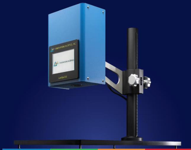
LumiSun™-50は、ASTM E927、IEC 60904-9、JIS C 8904-9 Class AAAに準拠した、革新的でコンパクトな卓上型LEDソーラシミュレーターです。時間安定性の要件を満たしています。出力パワーは0.1~1.5サンズまで可変でき、フロントパネルのタッチスクリーンでユーザーフレンドリーな操作が可能です。遠隔デジタル制御はModus RTU通信プロトコルのRS-485インターフェースです。LumiSun™-50は、世界中の大手PVメーカーで使用されているOEMソーラシミュレーターと同じ、最先端のLEDアレイと光学系を搭載しています。
